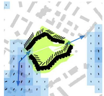
Abb. 70: Wohnsiedlung Triemli, Beschattung des Innenhofs durch südliche Randbebauung; Öffnungen in der Bebauung ermöglichen den Kaltluftaustausch mit dem übergeordneten Kaltluftsystem.
