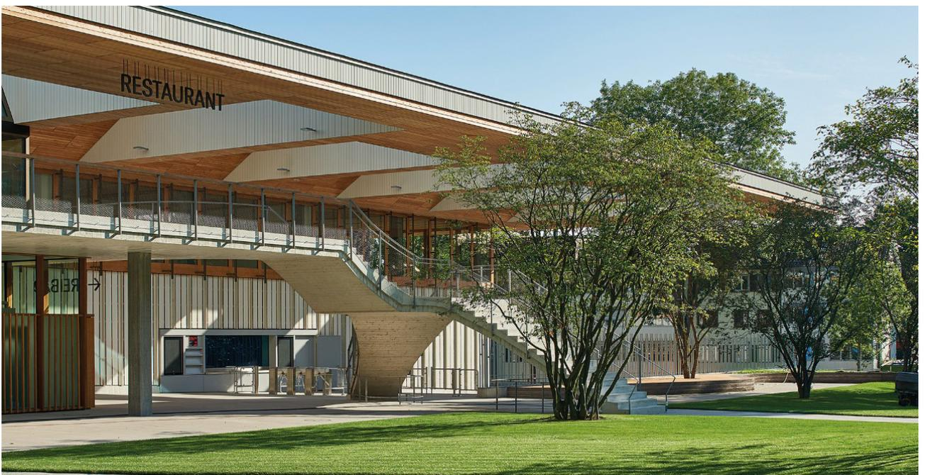
Abb. 147: Sonnenschutz durch Dachauskragungen am Sportzentrum Heuried
