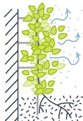
Abb. 131: Die Temperatur an einer begrüneten Fassade kann im Gegensatz zu einer konventionellen Fassade um bis zu 6 °C gesenkt werden.
